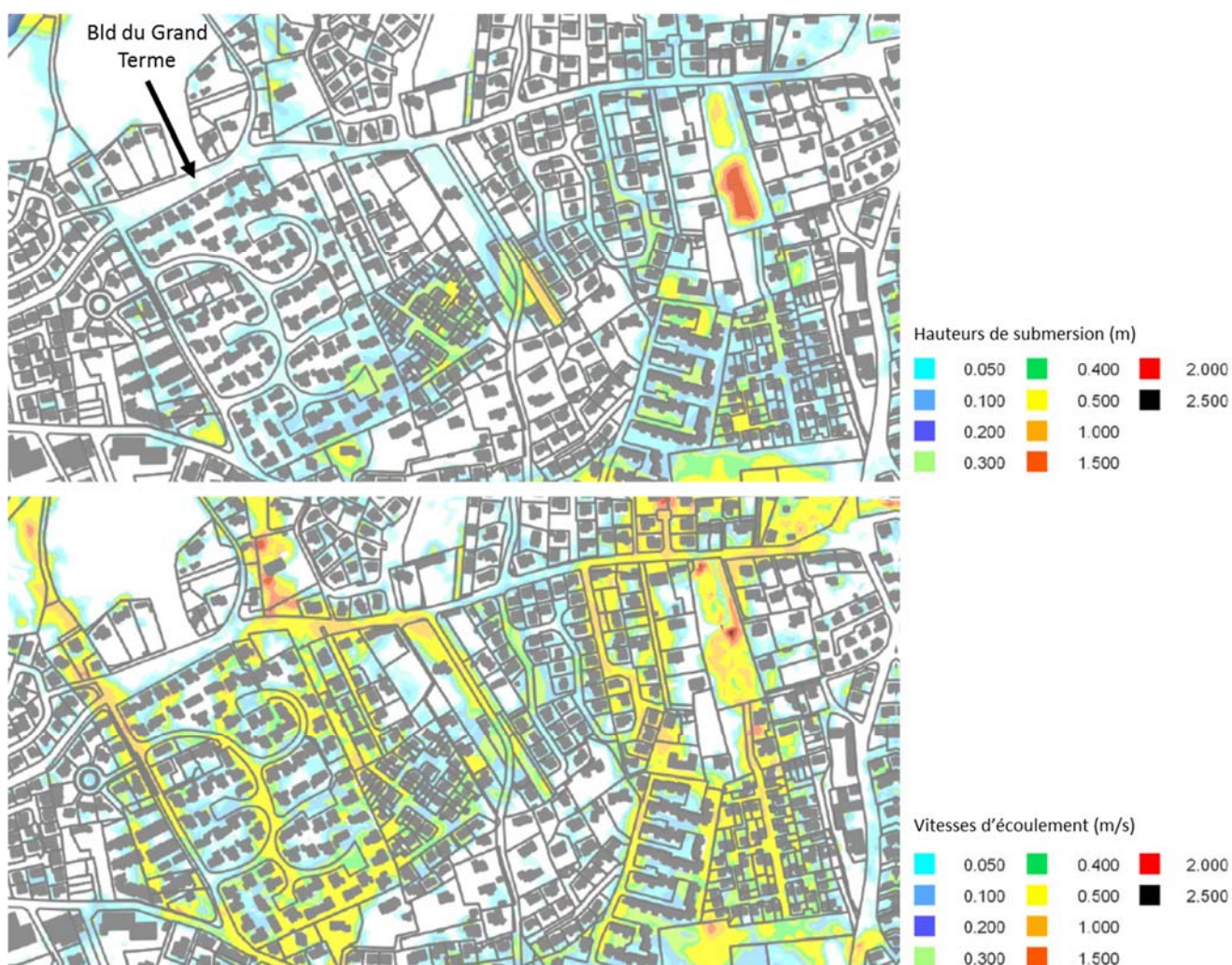
Illustration 10 : Hauteurs de submersion et vitesses d'écoulement pour la crue d'occurrence centennale sur le secteur des Lardières / Grand Terme.
