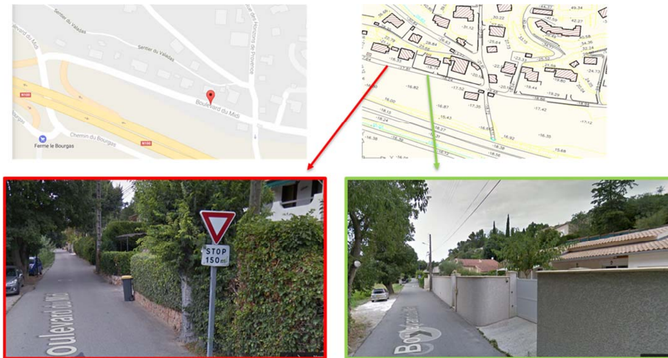
Illustration 7 : Exemple des types de murs disponibles sur le levé Lidar (en vert) et non disponible (en rouge).
